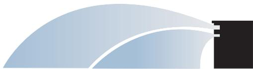
Las toberas Serie U ofrecen una distribución de agua mejor y más uniforme. El agua que sale de ambos orificios se combina para formar un chorro continuo. Elimina las zonas secas para una cobertura más uniforme en toda el área de riego.
